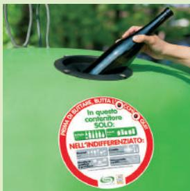
È il sistema più conosciuto, economico ed efficace, per raccogliere in modo efficiente i rifiuti di vetro. Le campane hanno una capacità che varia da 2 a 3 m<sup>3</sup> e sono posizionate in diversi punti della città. In linea generale, viene installata **una campana ogni 250/350 abitanti e con distanza massima di conferimento non superiore ai 250 m**.
