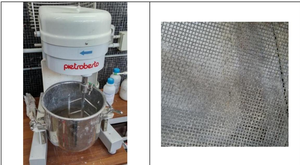
Figura 4: a sinistra, il mescolatore utilizzato per il mescolamento del materiale da granulare; a destra, la griglia utilizzata per alimentare il tubo di essiccazione.
