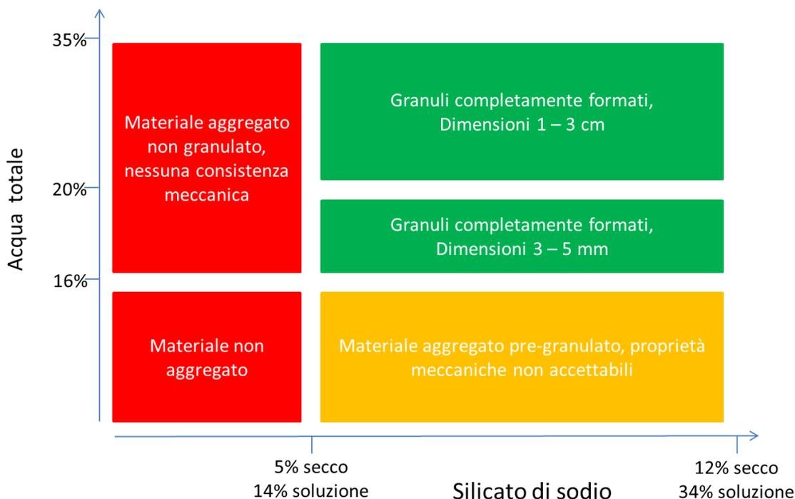
Figura 7: grafico riassuntivo della valutazione delle diverse ricette utilizzate nel corso della ricerca.
