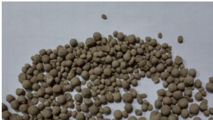
Figura 3: granuli ottenuti dal materiale ultrafine.
